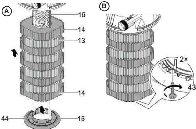
**B.** Fije de nuevo el disco de fijación con los dos tornillos (43) en las barras de limpieza.
