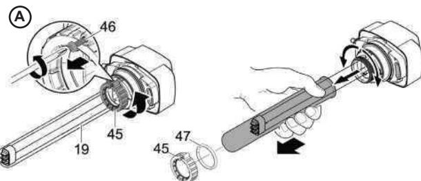
B. Saque la lámpara UVC (49) del zócalo de la lámpara.
